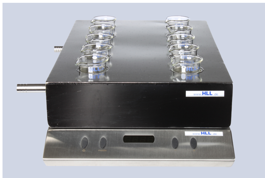
Abb. Temperierblock Clean Save Jacket 5000 mit Magnetrührwerk für 10 Bechergläser á 50 ml L505668*
